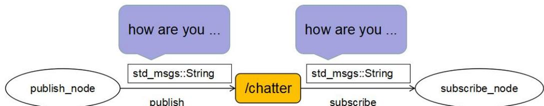
(图 16) 消息发布与订阅 ROS 通信网络结构图
