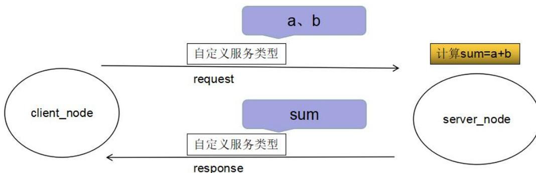
**(图 20) 服务请求与响应 ROS 通信网络结构图****(1) 功能包的创建**
