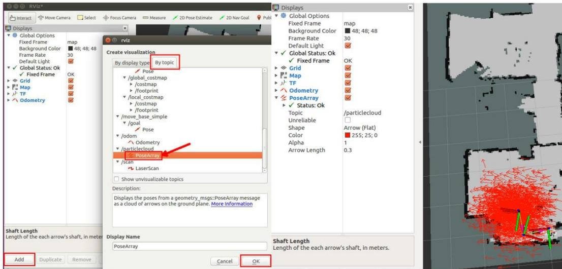
(图 34) 添加机器人位置粒子滤波点显示
