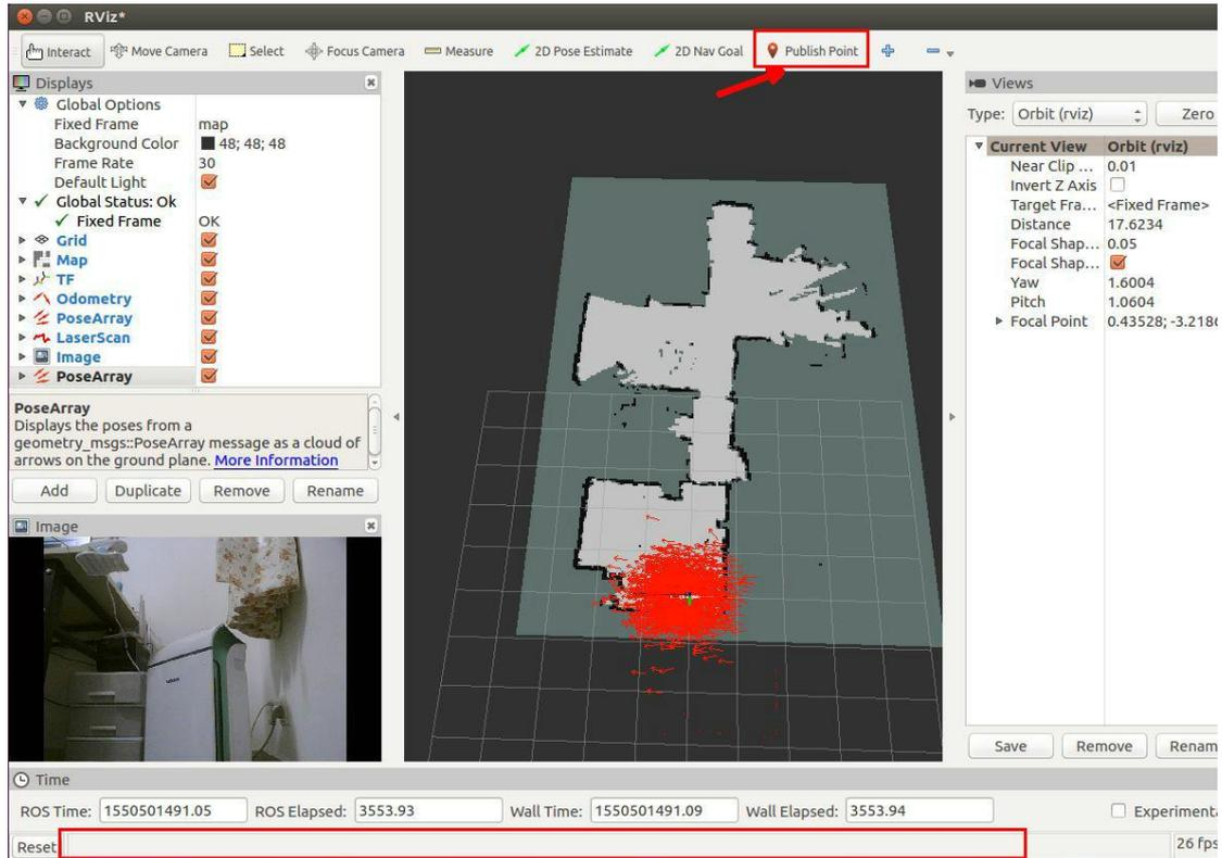
(图 39) 获取地图中指定点的坐标值
