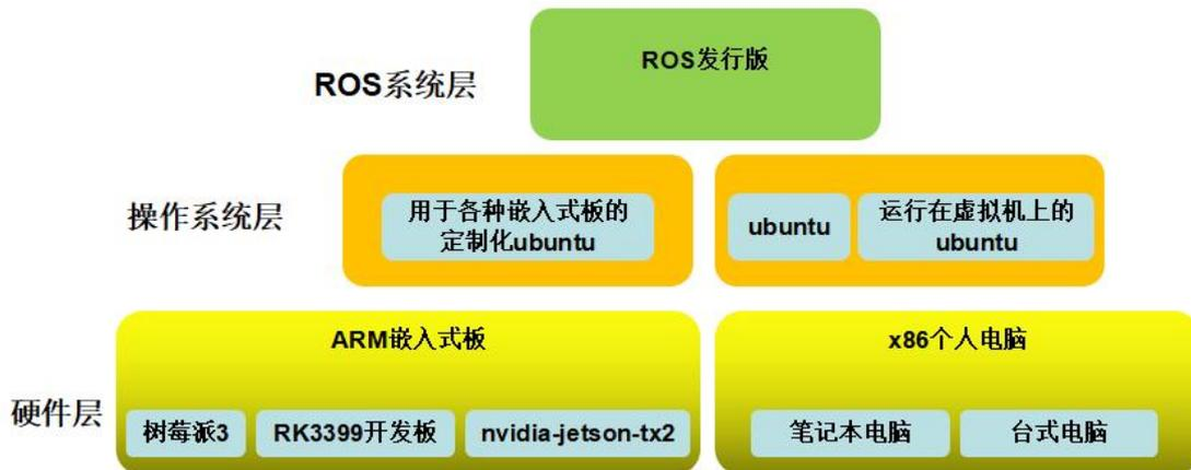
(图 9) 安装 ROS 软硬件配置总结
