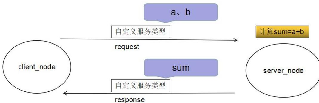
(图 24) 服务请求与响应 ROS 通信网络结构图
