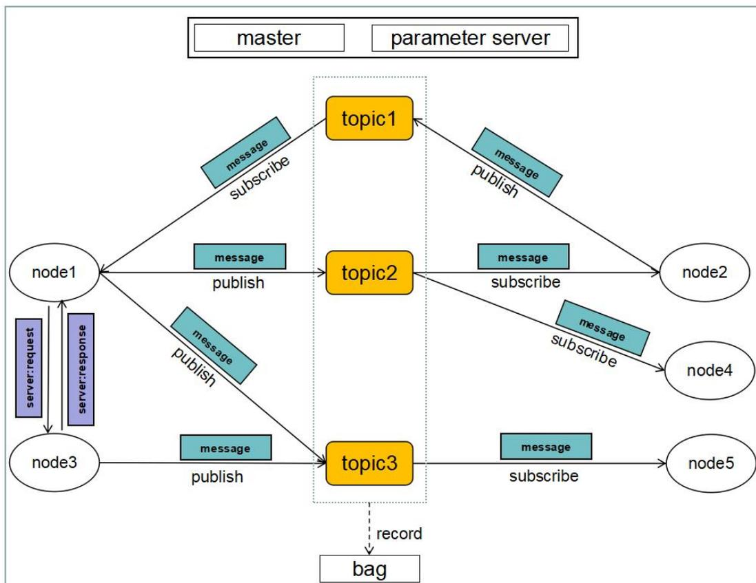
(图 6) 计算图级理解 ROS 架构
