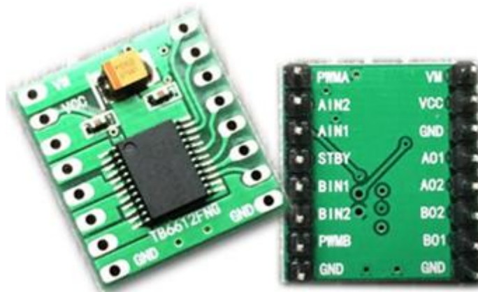
(图 3) TB6612FNG 电机驱动
