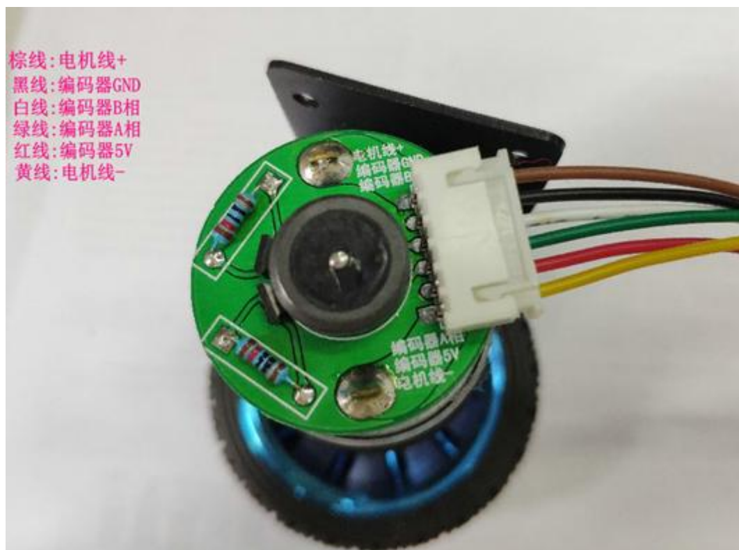
(图 2) 电机接线端口
