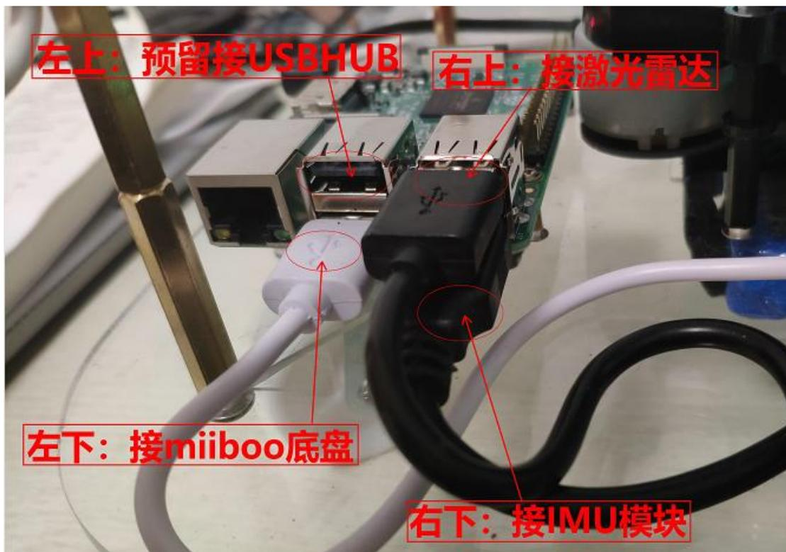
(图 29) miiboo 机器人的底盘、雷达、IMU 插入树莓派 3 的 USB 口物理孔位顺序
