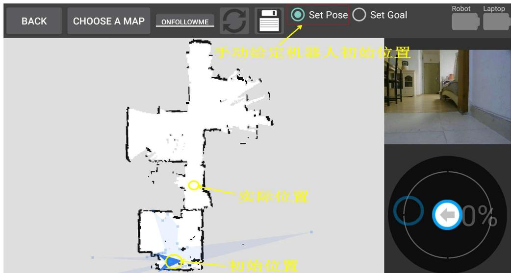
(图 47) 在 miiboo 机器人 APP 中手动给定机器人初始位置
