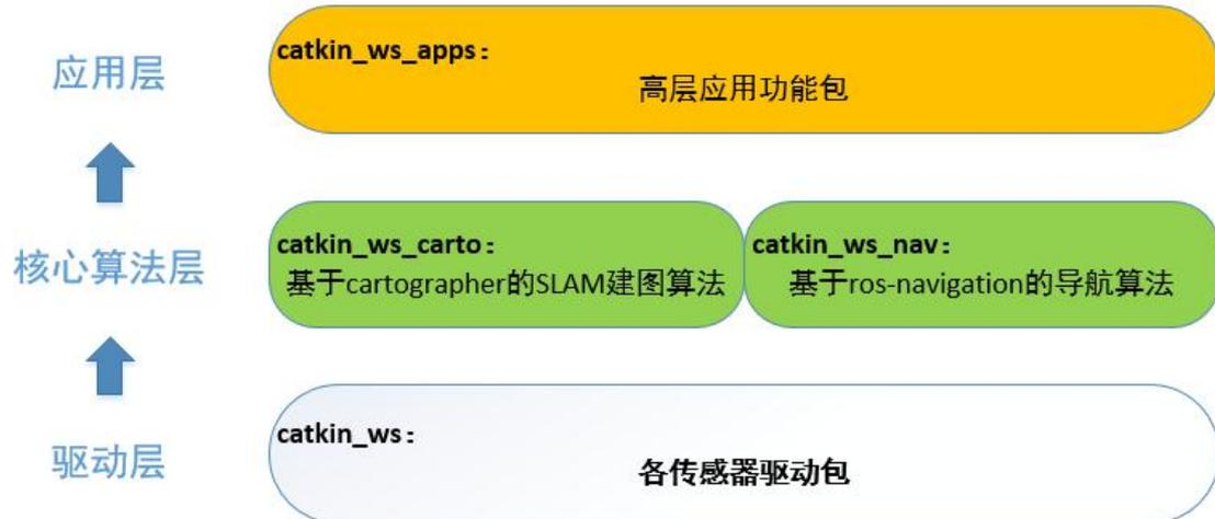
(图 50) miiboo 机器人编程的框架思路
