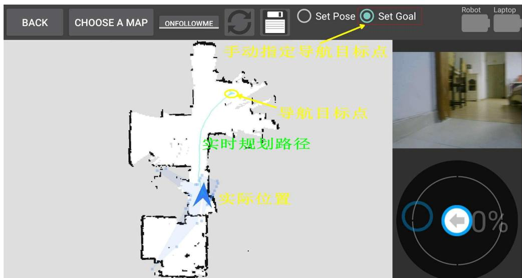
(图 48) 在 miiboo 机器人 APP 中手动指定导航目标点
