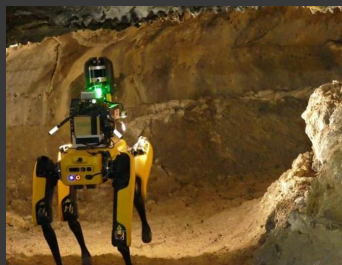
岩洞勘测机器人
